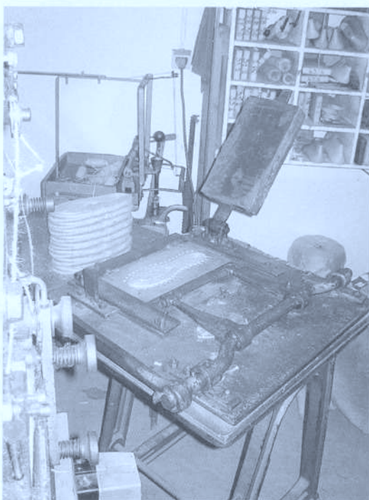
Figs. 10 a & et 10 b. Le «moule» est alors emprisonné dans une «compresse» faite de deux mâchoires dont une est en creux, et épouse très exactement la taille du «moule» (elle est également calibrée sur la peinture; autant de peintures autant de «compresses»). La partie qui reçoit le «moule» est bordée de pointes qui l'emprisonneront, l'empêchant de se déformer. Ceci fait, l'ensemble est compressé, la semelle prend alors une forme définitive qui lui falloit pérenniser; ce sera l'objet de la prochaine étape.
