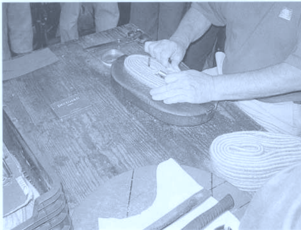
Fig. 9. Il enfilera l'extrémité de la tresse dans la «chucha» (gros cône en métal – voir Fig. 5 a). Ceci lui permettra de fixer l'extrémité coupée dans l'épaisseur des dernières rangées de tresse et d'éviter son déroulement.
