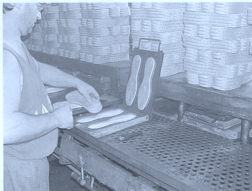
Fig. 20. Les semelles de corde sont placées dans le moule sur les lames de caoutchouc.
