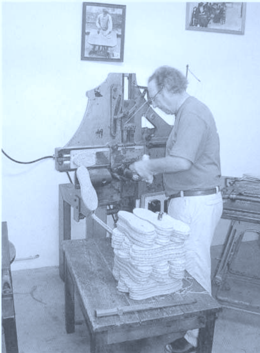
Figs. 11 a & 11 b. Enserée dans les pointes de l'une des mâchoire, la semelle («moule») et partie de la «compresse» est montée dans une machine (ici c'est une «Machine Milhet»). On va ainsi coudre les futures semelles en solidarissant les replis de la tresse. La couture traversera donc toute l'épaisseur de la semelle (autrefois on cousait à la main sur un chevalet). On enfile les «moules» et «compresses» d'un côté; la semelle cousue est éjectée en fin de parcours. Toutes les semelles restent reliées les unes aux autres par le fil de la couture.
