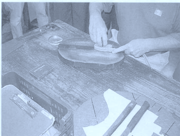
Fig. 5 b. Tresse est mise sur la forme, laquelle a été au préalable réglée (grâce à des petites tiges métalliques pouvant se déplacer sur la grande bande métallique percée de trous), afin de faire une peinture donnée. Ces deux petits repères permettent de régler la dimension du «cœur» et du «talon» de la future semelle. C'est ce que montre le cliché suivant.
