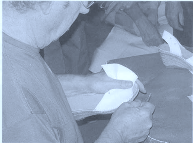
Fig. 15. On va coudre le dessus de l'espadrille ou «tipe» (correspondant à l'ensemble «empeigne» et «talon»). Cette opération est le montage. Autrefois il se faisait à la main avec un gros dé placé dans un gant couvrant la paume de la main et laissant le pouce libre (15 a).
