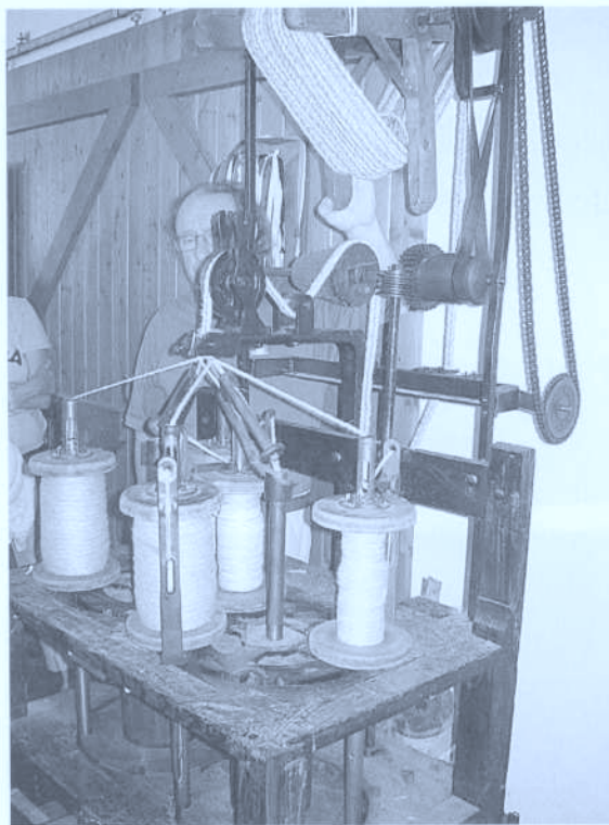
Fig. 2. Machine servant à tresser le jute ; la machine est alimentée par des bobines se trouvant au niveau inférieur ; elles alimentent à leur tour les bobines que nous voyons à l'étage moyen, dont les fils sont tressés par la machine. La tresse formée s'enroule à la partie supérieure.
