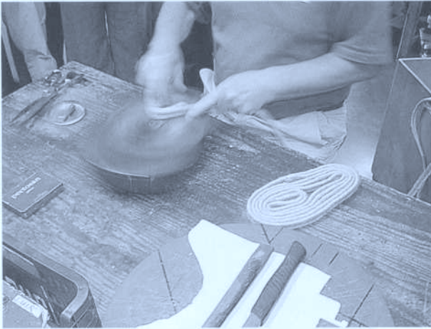
Fig. 7. Revenons à l'étape précédente. A l'aide de cette forme qui tourne sur un axe, le «mouleur» effectue le «moulé» ou première ébauche de la semelle; le nombre de tours de tresse est donc fonction de la pointure.
