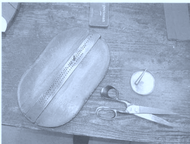
Fig. 5 a. Pièce à faire «les moules», ciseaux pour couper la tresse et «chucha» (embout métallique qui servira à enfiler l'extrémité de la tresse dans la masse mise en forme).
