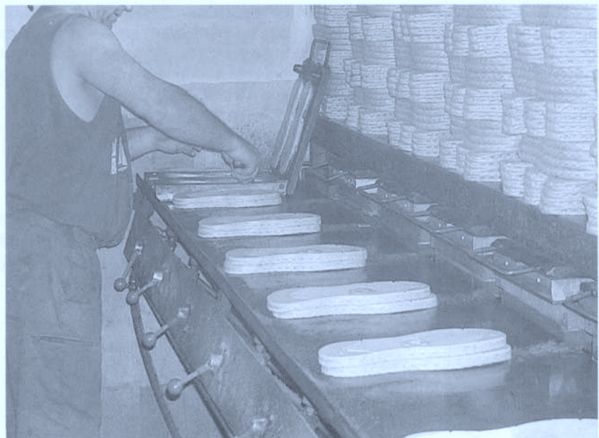
Fig. 22. Les semelles sont retirées du moule après vulcanisation des lames de caoutchouc sur les semelles de corde.
