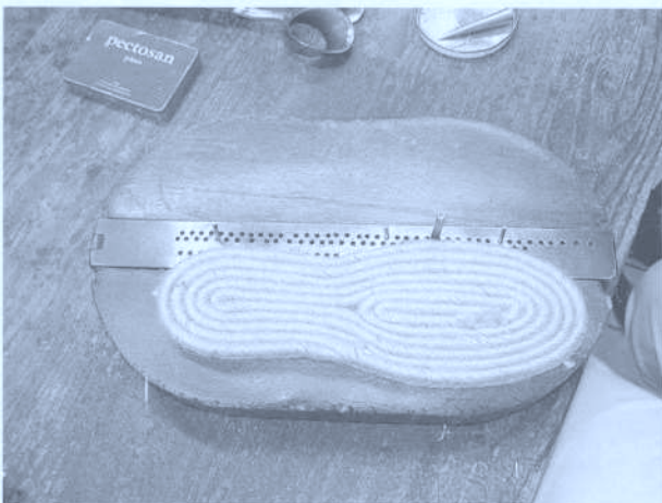
Fig. 6. Côte à côte, en stricte correspondance, on voit les réglages de la forme (en bois) et de la semelle achevée. On observe la correspondance entre l'emplacement des petites tiges de fer et les zones de replis de la tresse au niveau du «cœur» et du «talon».
