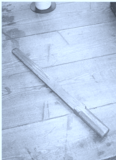
Figs.13 a & 13 b. On vérifie la pointure des semelles grâce à un outil gradué en pointures anglaises et européennes.
