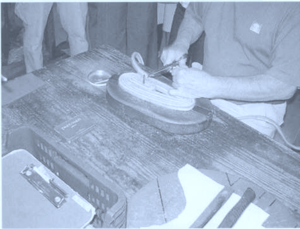
Fig. 8. La pointure étant formée, le mouleur coupe la tresse.
