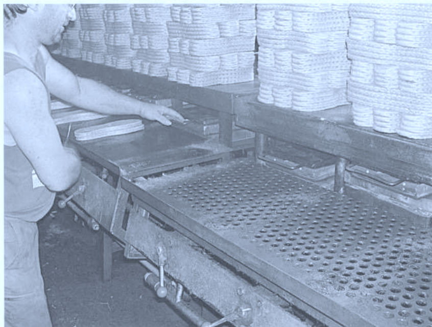
Fig. 21. Le moule est refermé et chauffé dans le "four".
